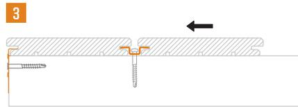
Insérez la planche suivante et rapprochez-la au maximum, au moyen de sangles de parquetier si nécessaire.
