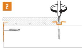
Vissez, sans serrer, jusque sous le profil au moyen de l'embout Torx 20
