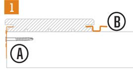
Positionnez la première planche et maintenez-la bien en place avant de placer les B-Fix Border (A) et puis les B-Fix One (B).
