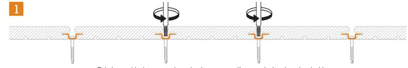
Dévissez légèrement les vis de part et d'autre de la planche à démonter.
