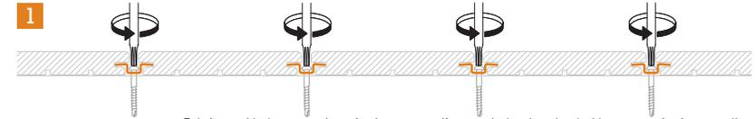
Dévissez légèrement les vis de part et d'autre de la planche à démonter ainsi que celles des deux planches voisines (gauche et droite).
