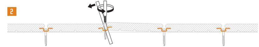
Écartez les planches à l'aide d'un levier (pour éviter d'endommager le profil) et dévissez complètement.
