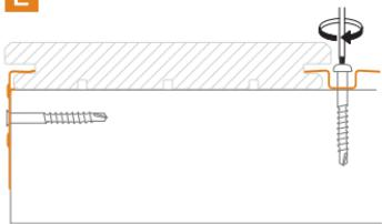
Placez le B-Fix Border sur la coupe de la lambourde. La petite "casquette" doit-être posée sur la surface supérieure du chevron. Vissez dans le trou supérieur du B-Fix Border, jusqu'à serrage, au moyen d'un embout Torx 20. Alignez ensuite vos différentes lambourdes à l'aide d'une ficelle.
